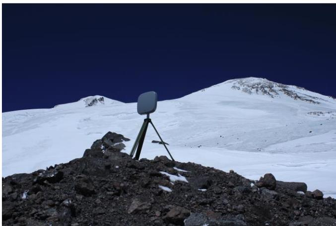
«РАДЕСКАН» позволяет производить круглосуточный радиолокационный мониторинг охраняемой территории на дальностях до 3000 метров, с возможностью передачи информации по радиоканалу на удаленный пост охраны. Имеется функция автоматического «сопровождения» выбранной цели и передачи на пульт тепловизионного и/или видео изображения цели для ее подробной идентификации.
