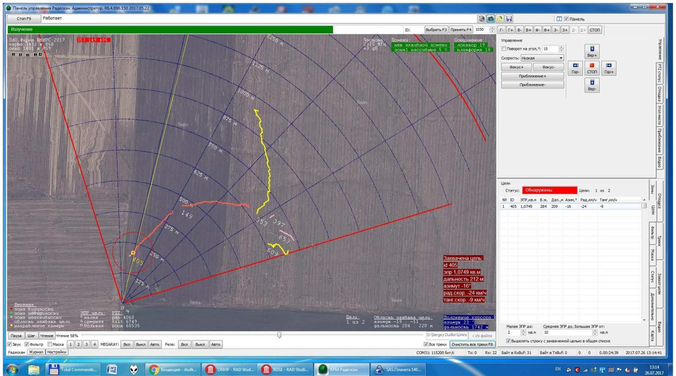
При приближении к РЛС «РАДЕСКАН», квадрокоптер был обнаружен и сопровождался на экране АРМ оператора на дальности от 1053 м до 212 м. При высоте полета цели – 120 м.
