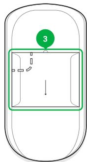
3 - Крепежная панель SmartBracket (перфорированная часть необходима для срабатывания тампера при попытке оторвать датчик от поверхности).
