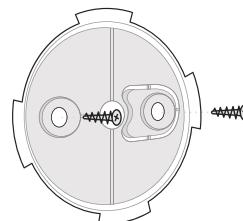
2. Наденьте сирену на панель SmartBracket и проверните по часовой стрелке – мигание светового индикатора подтвердит, что тампер сработал.
