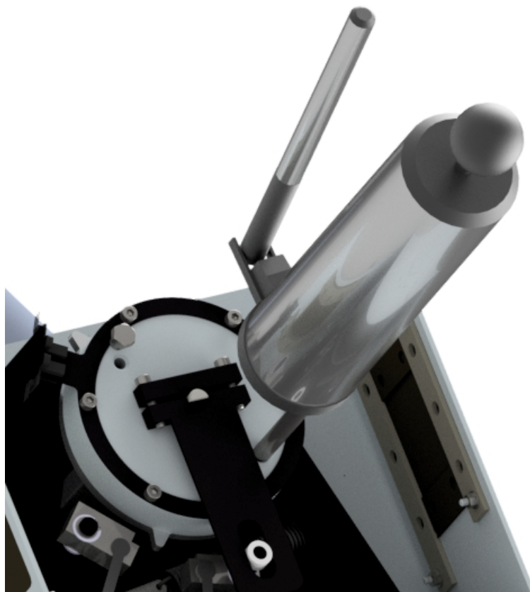
Рисунок 26 – Доливка демпферной жидкости
