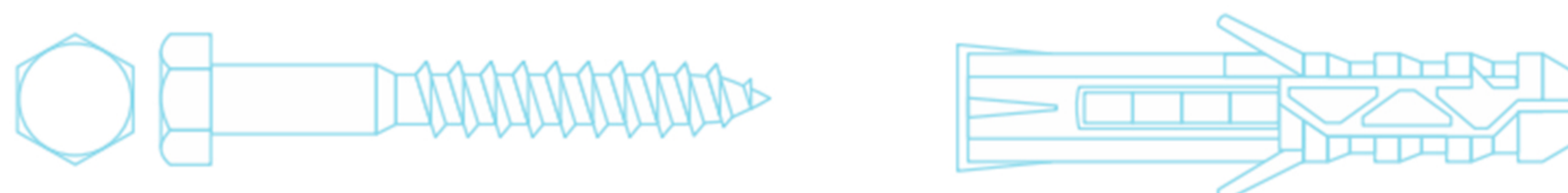
Рисунок 13 – Шуруп с шестигранной головкой «Глухарь» с дюбелем
