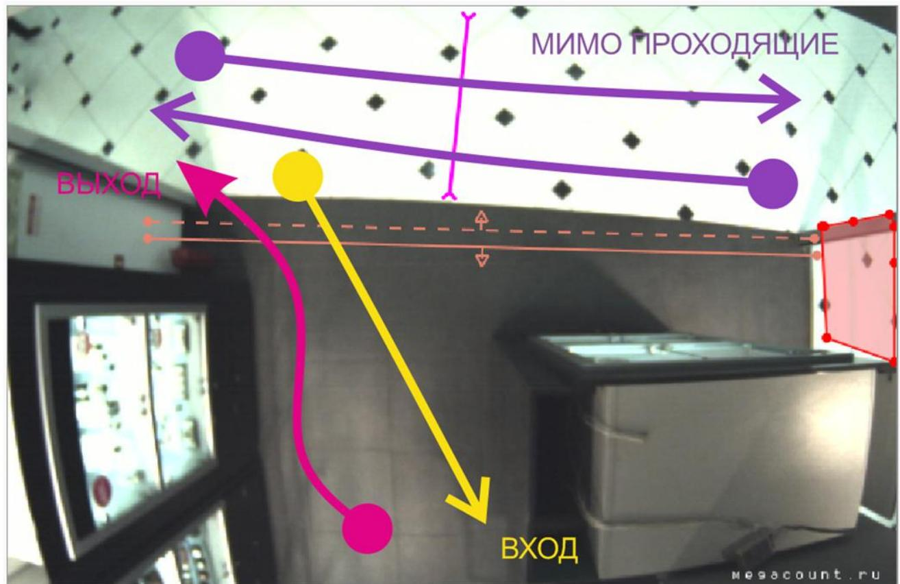
Данная комбинация оптимальная подходит при установке видеосчетчика снаружи торговой точки, счетчик позволяет вести подсчет входящих в объект посетителей и проходящих мимо, что дает возможность вывести конверсию мимо проходящего трафика и вошедших в объект
