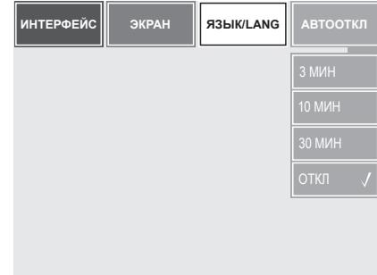
Рис. 8 Настройка таймера автоВыключения
