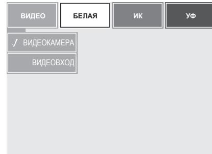
Рис. 6 Выбор источника видеосигнала
